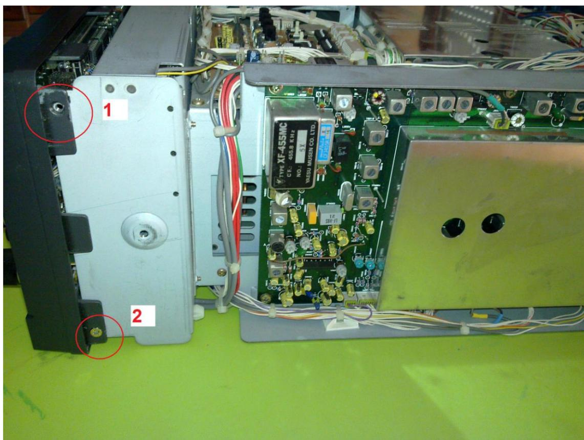
6. Far ruotare tutto il frontale facendo perno sulle viti, indicate dalle foto precedenti con i numeri 2, portando lo stesso come le figure di sotto:
